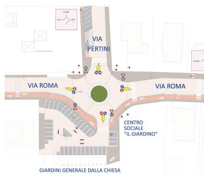
**Sono partiti lunedì 14 novembre i lavori per la realizzazione della nuova rotatoria in via Roma, a Figline, all'incrocio con via Pertini.** In particolare, si tratta di una rotatoria di 27 metri di diametro (corsia stradale di 7 metri), progettata dall'ufficio Tecnico del Comune di Figline e Incisa Valdarno e da realizzare in 99 giorni dalla ditta Valdarno Strade.
